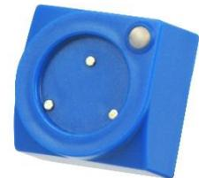
Je nach Kommunikationsschnittstelle sind die Kommunikationsvarianten in einer kompakten Bauform oder mit abgesetztem Lesekopf erhältlich. Auf dem Lesekopf wird der Schlüssel mittels eines Magneten festgehalten und über Kontakte ausgelesen. Bei Geräten mit abgesetztem Lesekopf ist dieser Lesekopf über eine Kabelverbindung mit der sogenannten Elektronikeinheit verbunden.
