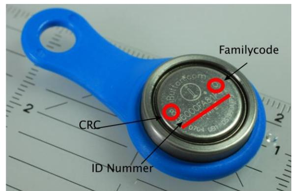
Abbildung 4: Bedeutung der aufgelaserten Beschriftung des Schlüssels
